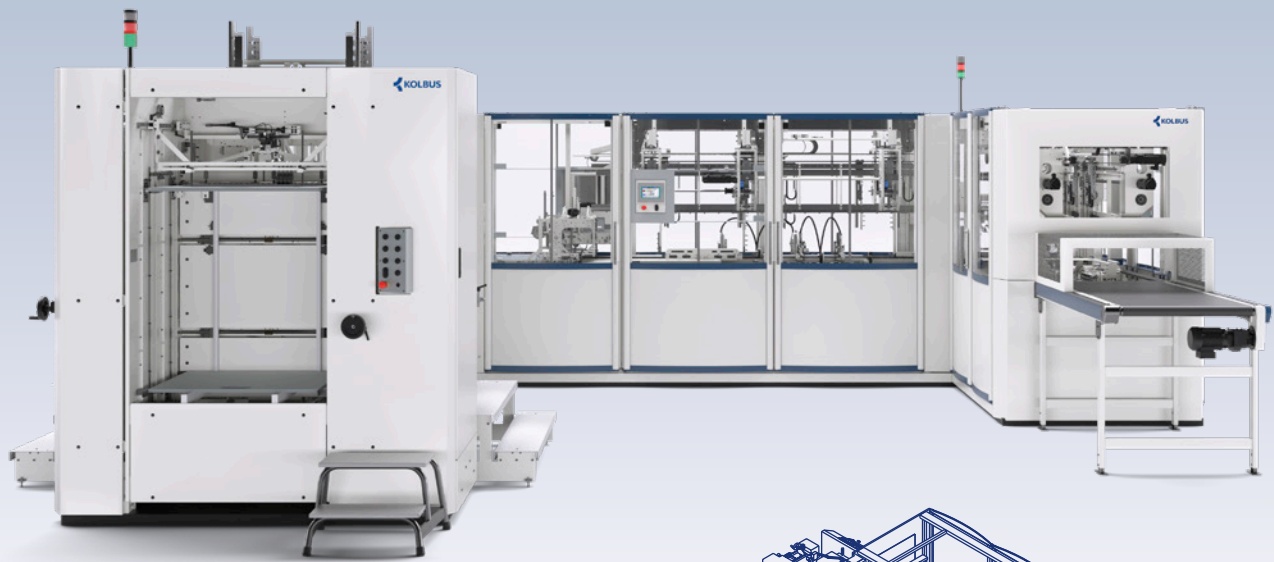
BLT 200 und Box Line Wrapper BLW 200 – zum Formen und Kaschieren von Boxen
