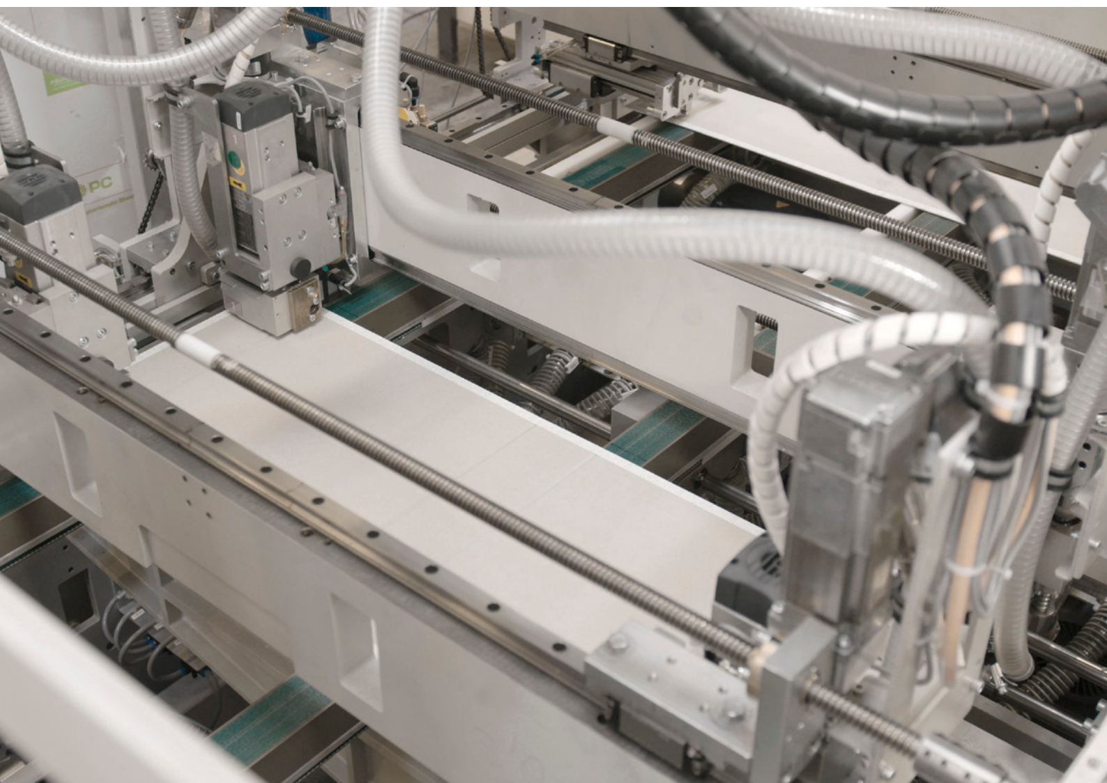
Magneteinleger BLM 800 mit einer Leistung bis zu 40 Takten/min
