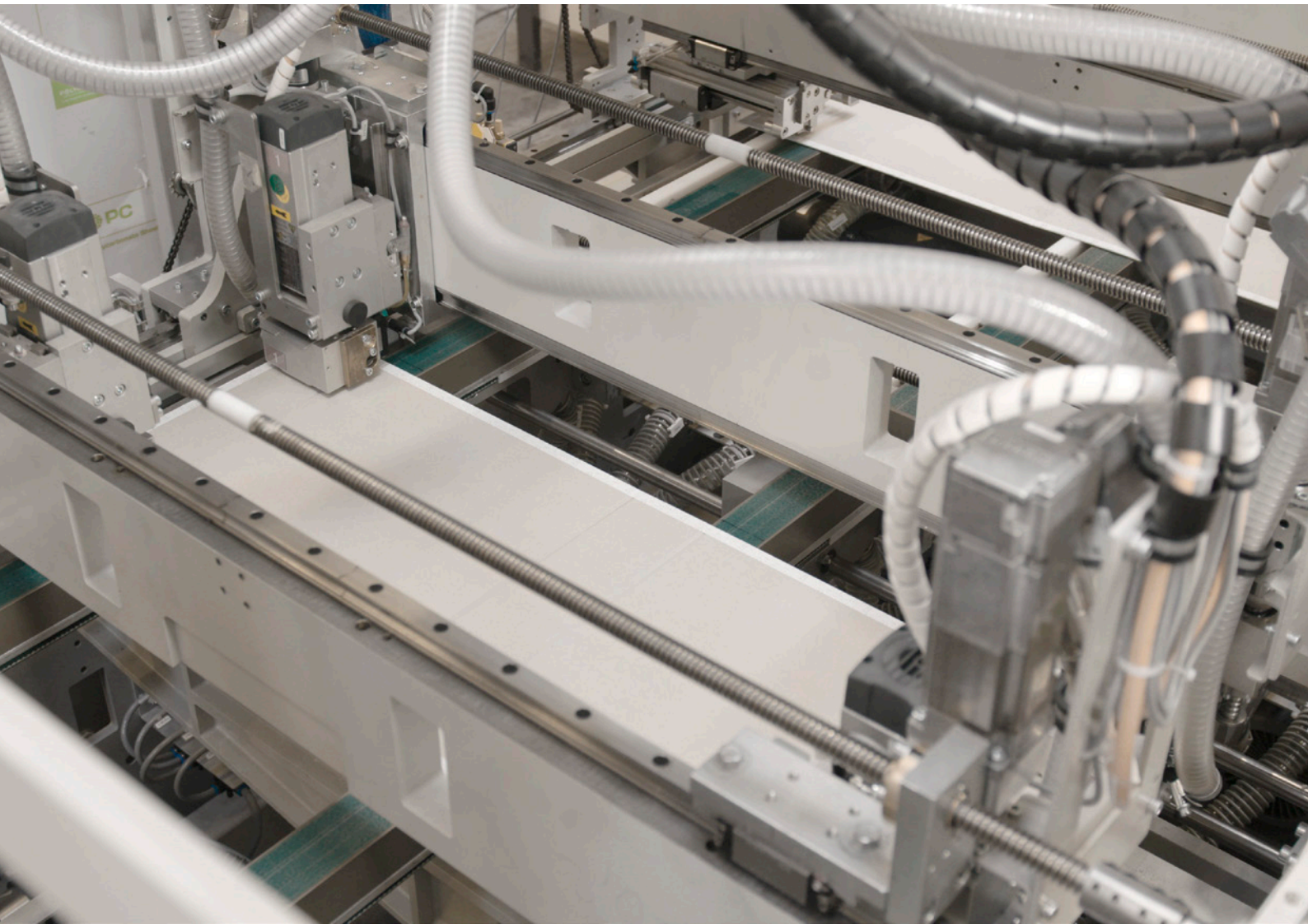
Magnetinleger BLM 800 mit einer Leistung bis zu 40 Takten/min
